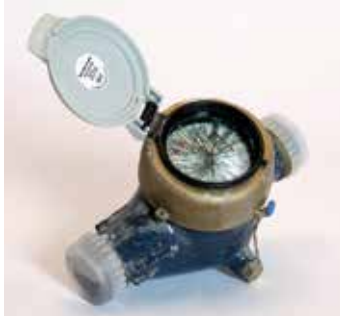
Ein trauriger Anblick: ein sogenannter „Frostler“, also ein durch Frost zerstörter Wasserzähler.
