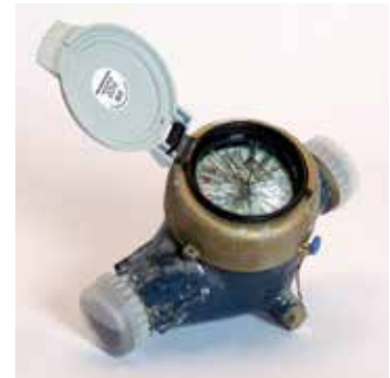
rechts: Ein vom Frost zerstörter Wasserzähler – ein sogenannter „Frostler“
