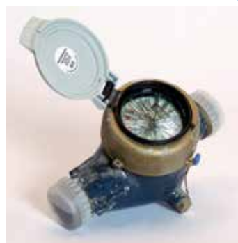
rechts: Ein vom Frost zerstörter Wasserzähler – ein sogenannter „Frostler“
